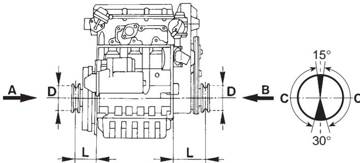
Courroie trapézoïdale  $D \text{ (mm)} \geq 114 [L \text{ (mm)} + 101] \frac{N \text{ (kW)}}{n \text{ (RPM)}}$
